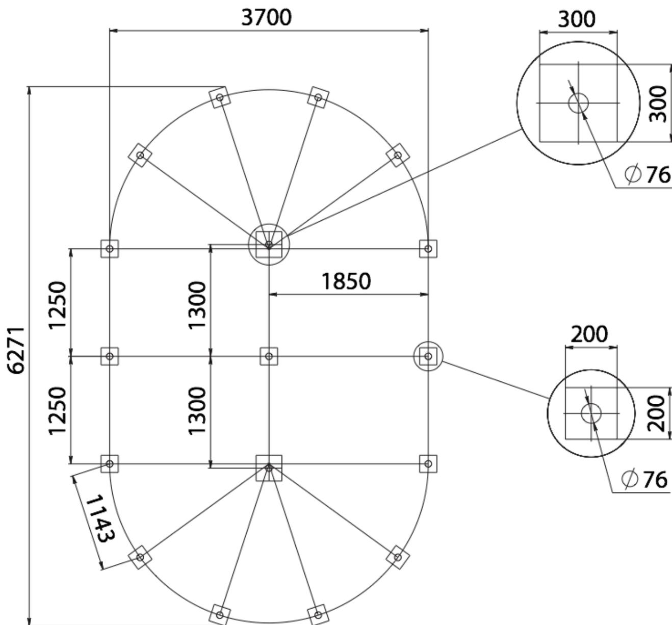
Возможно применение ленточного или монолитного фундамента; комбинирование свай по периметру и бетонной опоры в центре; иные виды фундамента.
