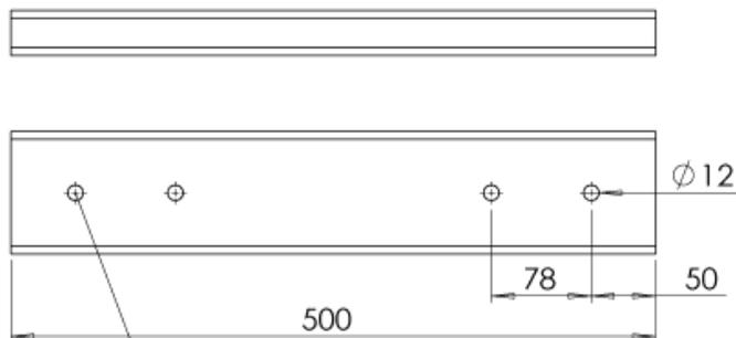
*Просверлите нагель и распорку насквозь. Показаны отверстия и их расположение. Закрепите распорку и нагель с помощью болта М12 с гайкой и широкой шайбой с обеих сторон. Всего по 4 болта на каждый нагель.*
