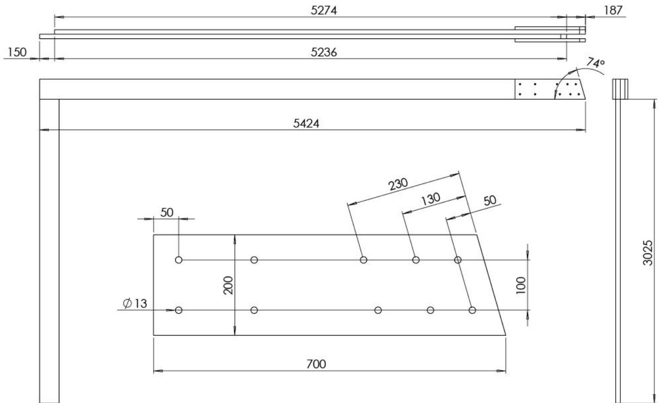
Опоры лаг пола и сами лаги пола второго этажа - это обыкновенные сухие доски хвойных пород. Крепежные накладные делают из ФСФ фанеры толщиной 30 мм.
