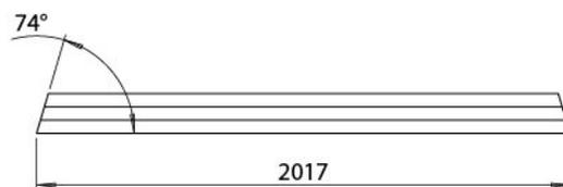
Балки ростверка в комплект поставки не входят, изготавливаются на месте из сухого пиломатериала.
