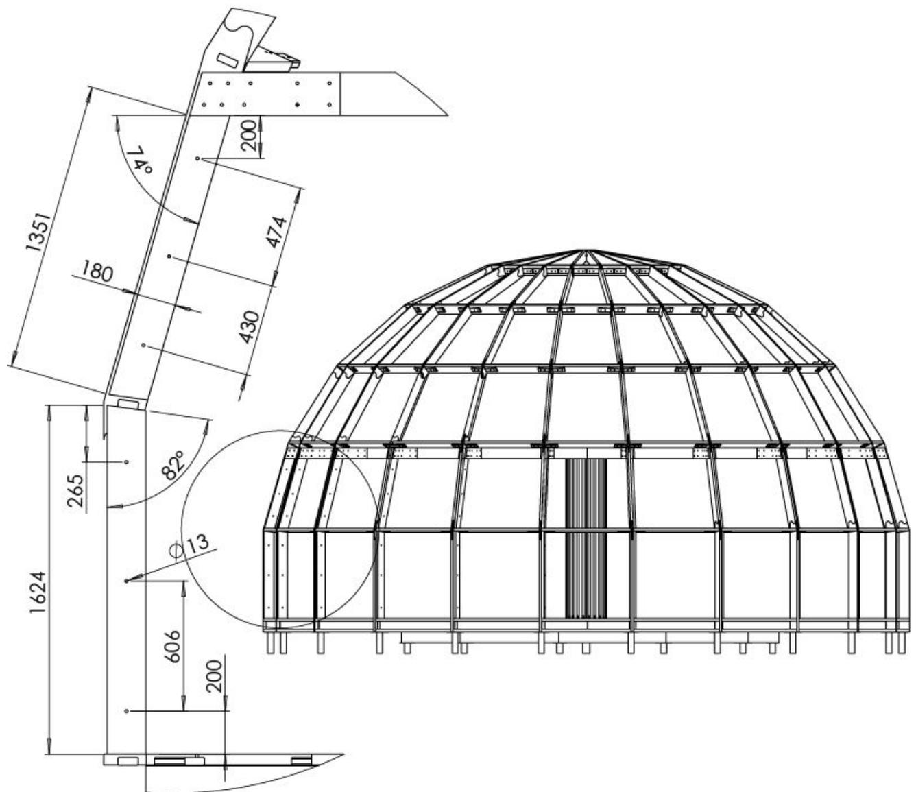
На вертикальные балки к которым крепятся лаги пола второго этажа крепятся две доски - усилителя, размеры которых указаны на рисунке выше. Эти доски крепятся к вертикальным лагам на 3-х болтах каждая.
