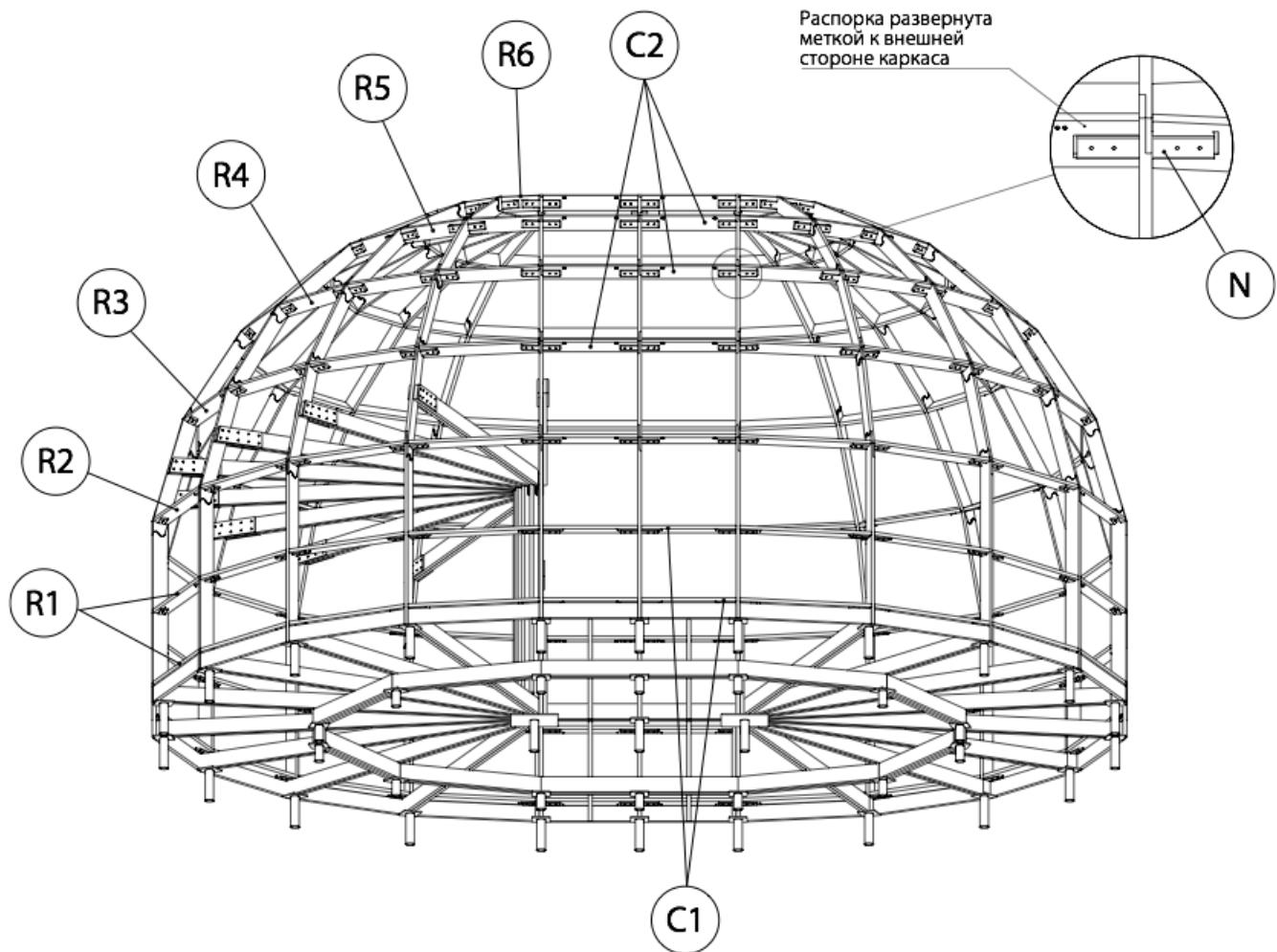
Просверлите нагель и распорку насеквость. Показаны отверстия и их расположение. Закрепите распорку и нагель с помощью болта M12 с гайкой и широкими шайбами с обеих сторон. Всего по 4 болта на каждый нагель.
