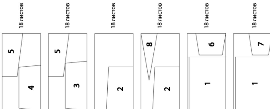
Для OSB размером 12x1250x2500. Обрезки материала пойдут на подшивку пола под утепление и соединительные планки для составных элементов. Обшивка не входит в комплект поставки и изготавливается самостоятельно.
