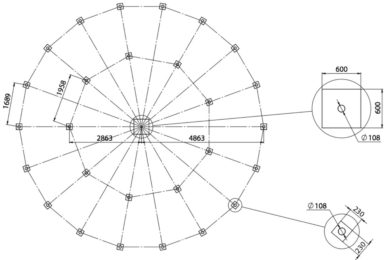
Возможно применение ленточного или монолитного фундамента; комбинирование свай по периметру и бетонной опоры в центре; иные виды фундамента.
