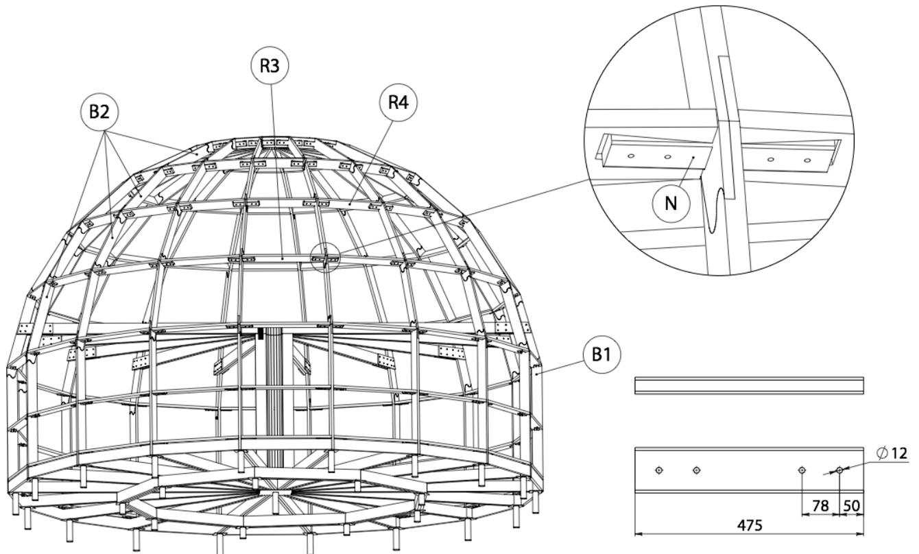
Просверлите нагель и распорку насквозь. Показаны отверстия и их расположение. Закрепите распорку и нагель с помощью болта М12 с гайкой и широкими шайбами с обеих сторон. Всего по 4 болта на каждый нагель.
