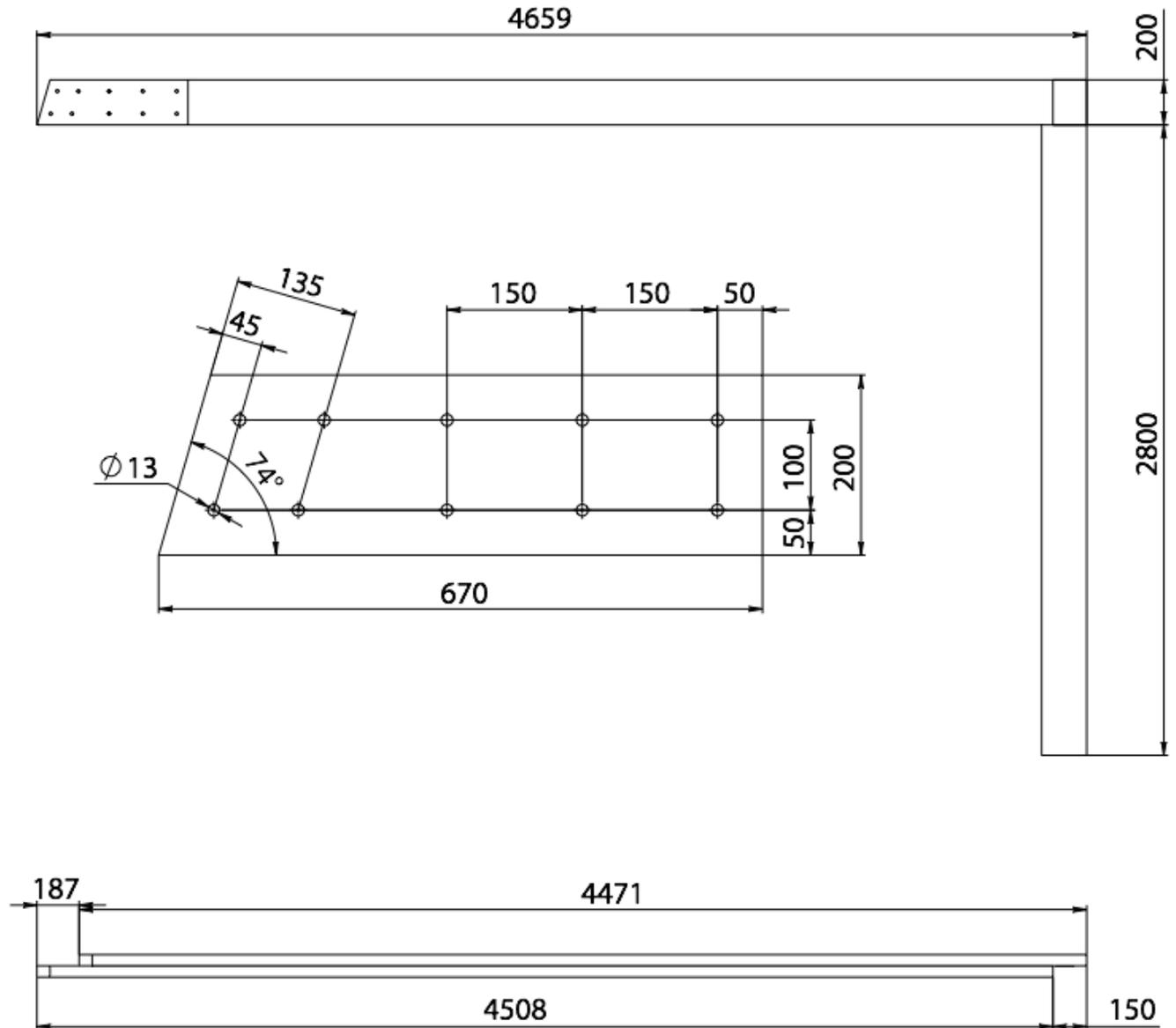
Опоры лаг пола и сами лаги пола второго этажа - это обыкновенные доски хвойных пород. Крепежные накладки делаются из ФСФ фанеры толщиной 30 мм. Рекомендуем оставлять достаточный второй свет для организации лестницы и максимальной эстетики конструкции.
